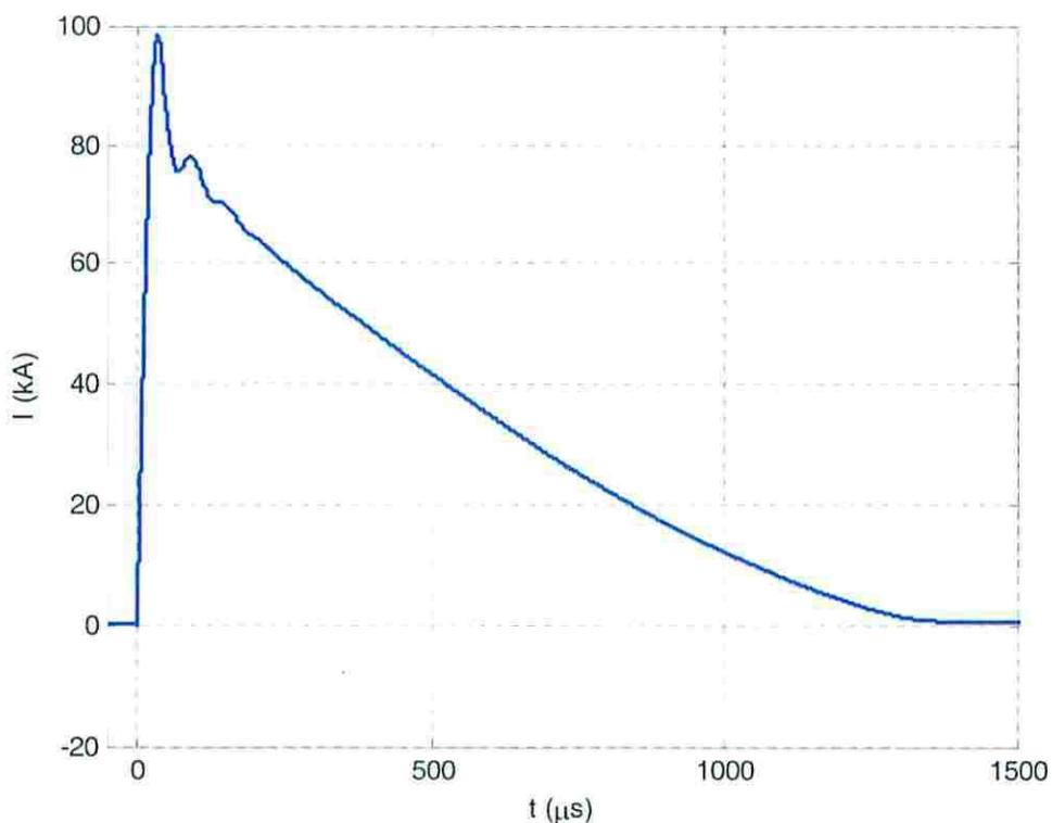
Figura10. Forma de onda correspondiente al ensayo KK08-12.
